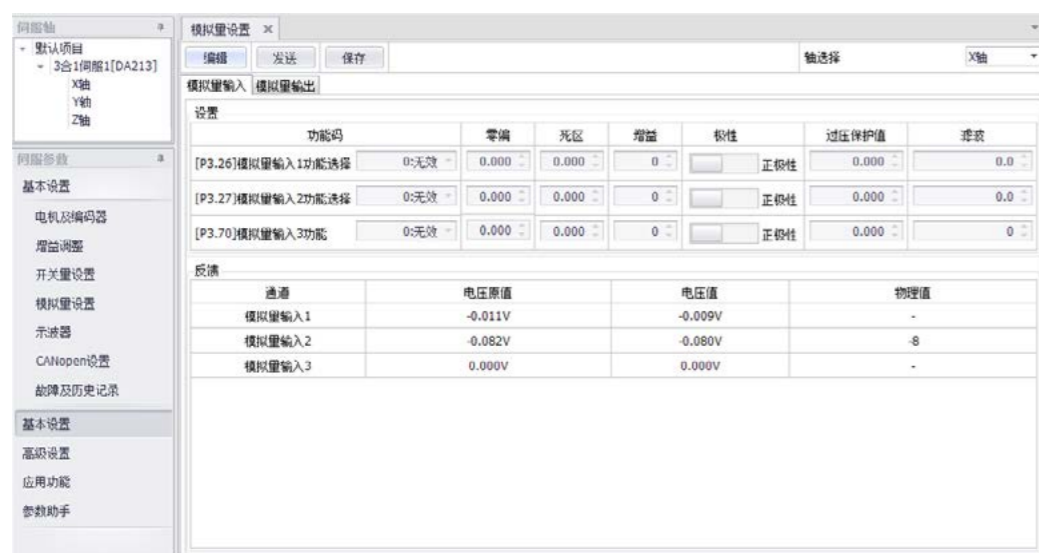
模拟量输入输出可以在图示中设定增益、零偏、死区等参数
